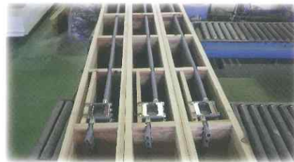
電気ボックス・配管を内蔵したパネル
